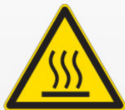
Pericolo superficie calda W017
