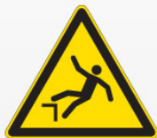
Pericolo di caduta con dislivello W008
