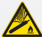
Pericolo bombola pressurizzata W029
