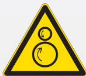
Attenzione rulli rotanti/ pericolo di trascinamento W025
