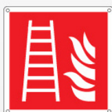
Scala antincendio F003
