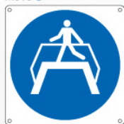
È obbligatorio utilizzare il ponte pedonale M023 ●
