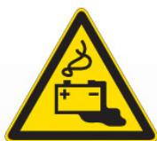
Pericolo batterie in fase di carica W026
