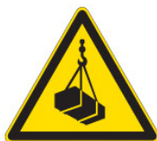
Pericolo carichi sospesi W015
