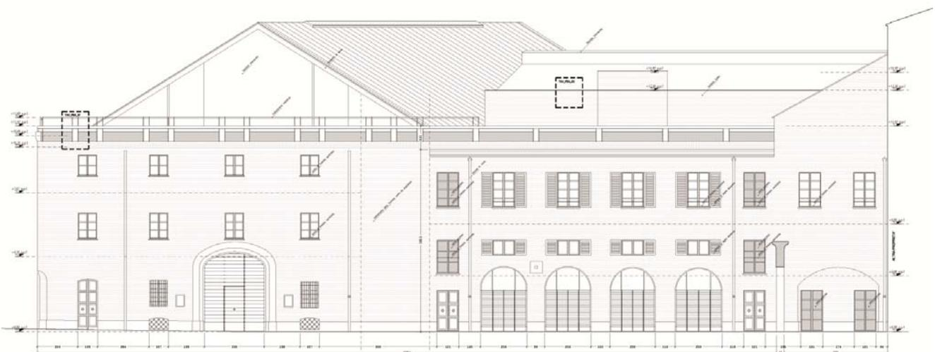
Prospetto verso la corte denominata Carrozzera: la facciata è oggetto di un attento intervento di restauro e di ripulitura delle parti ammalorate ma anche di un accorto ridisegno per quanto attiene il nuovo cornicione di coronamento. I serramenti sono stati integralmente sostituiti, con altri lignei, a causa del degrado in cui versano gli attuali; il volume della scala che consente di accedere al terrazzo, è rivestito anch'esso in tavole di legno.
