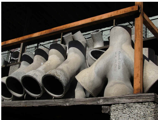
Foto 1 – Braghe di Eternit; materiale compatto.
