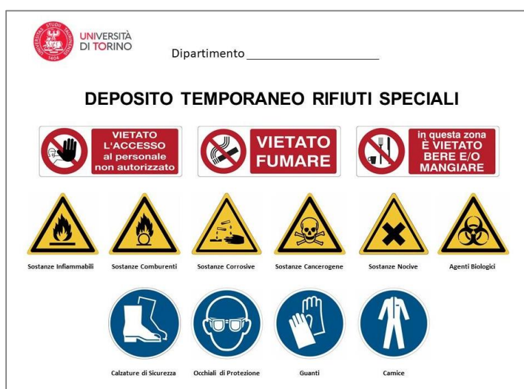
Figura 8. Cartellonistica da apporre all'ingresso del deposito temporaneo.
